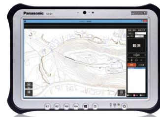
情報化施工の一つであるTS出来形管理の支援とCAD機能を搭載したポータブルシステムです。エクストレンド武蔵で作成した3次元設計データをクロスフィールドに取り込むことにより、施工現場でのトータルステーションを使った出来形計測や現場の丁張り設置などが簡単に行えます。
