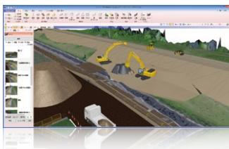
施工段階における現場の3Dモデル作成により、建設現場・施工手順を“見える化”するトレンドコア。地元住民への工事状況説明を手助けするビューアデータの作成もできます。国土交通省が推進するCIMおよび“i-Construction”を高度に支援いたします。
